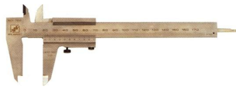
Figure 3-8 : Pied à coulisse à vernier
