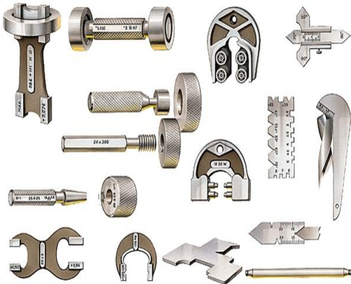
Figure 3-23 : Vérificateurs à tolérances
