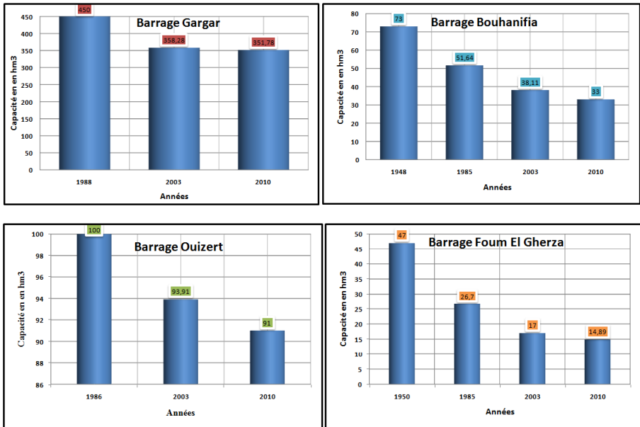
Figure 2 : Chute de la capacité par envasement.
