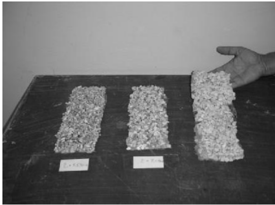
Figure 2 : Photographie de l'échantillon de grains de sable de rugosité équivalente : \varepsilon (mm) = 5,63 ; 7,14 et 9,11
