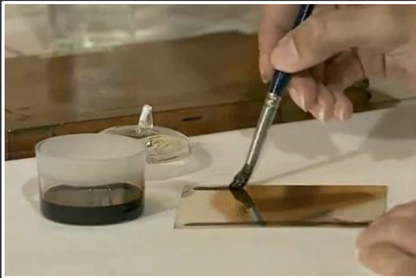
couches sensibles argentiques étalées sur un supports
